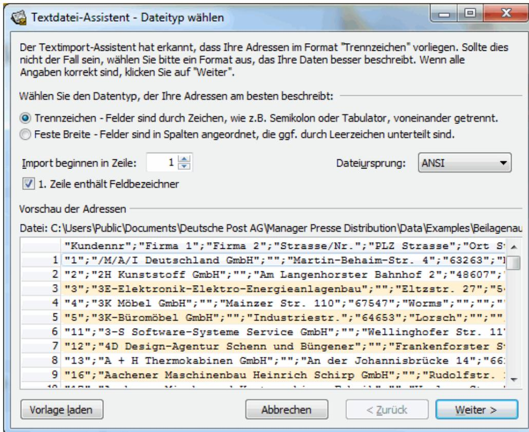
Der Assistent erkennt im ersten Schritt i.d.R. automatisch, ob in der Textdatei die Felder durch Trennzeichen voneinander getrennt sind oder ob eine feste Feldbreite vorliegt, sodass Sie den Dateitypen nicht mehr auswählen müssen.
